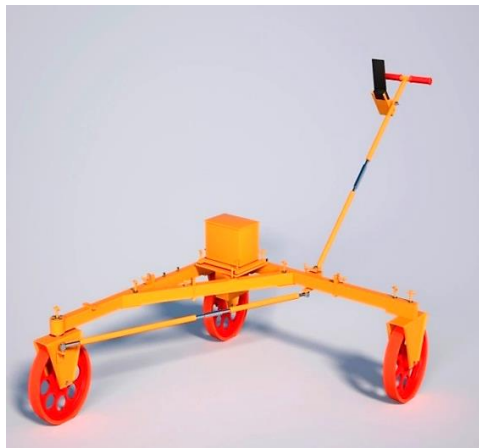
Рис. 5. Внешний вид УДК «Ровность»: а – с ручным приводом; б – на базе автомобильного прицепа
