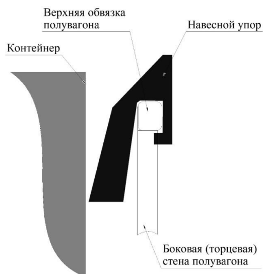
Рис. 5. Пример возможного размещения навесного упорного элемента крепления на верхней обвязке полувагона
