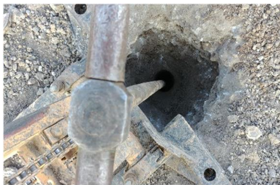
Рис. 3. Элементы системы мониторинга водно-теплового режима участка эксплуатируемого земляного полотна:
