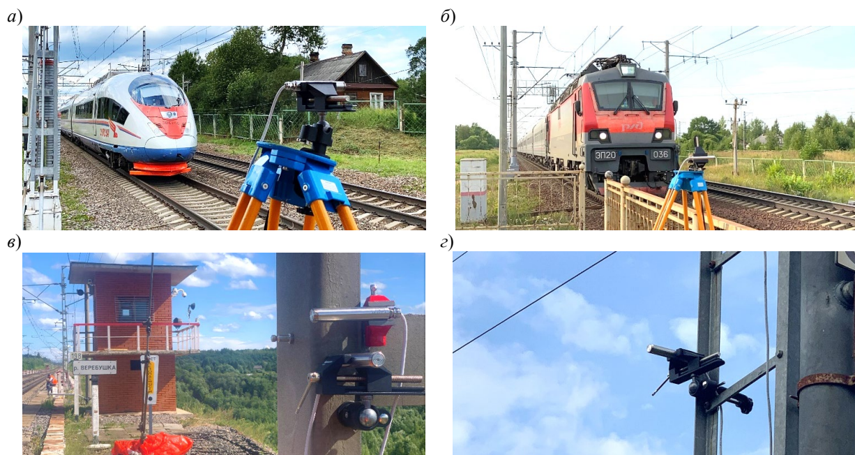
Рис. 2. Процесс измерения аэродинамического воздействия в местах: а – ст. Мстинский мост; б – платформа Саблино; в – 199-й км линии Санкт-Петербург – Москва; г – 405-й км линии Санкт-Петербург – Москва
