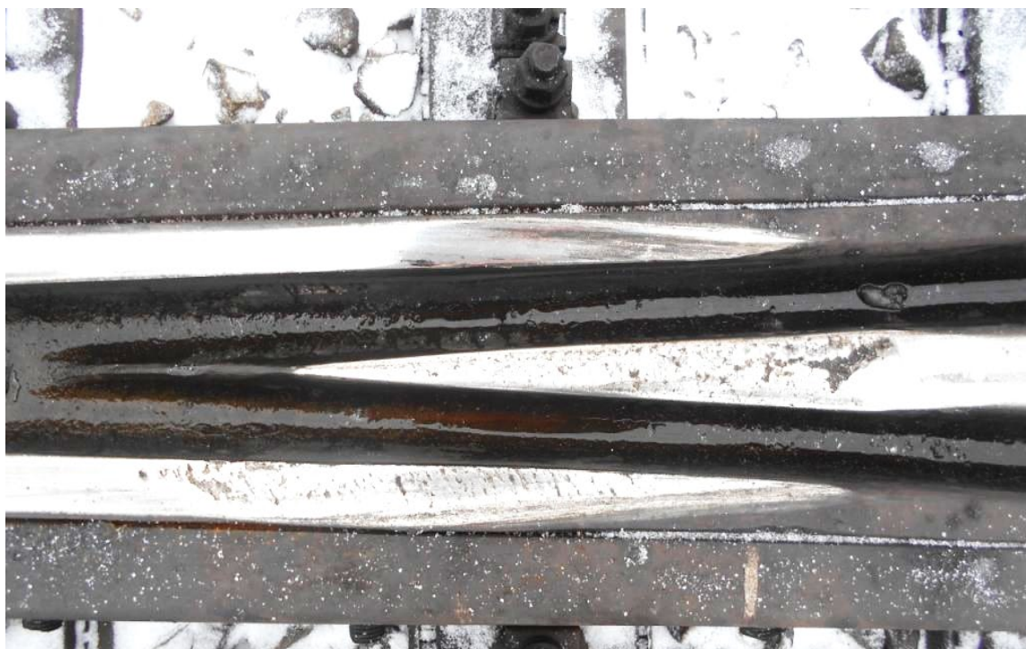
Рис. 4. Дефекты крестовины по коду ДС.14.2 и ДУ.14.2
