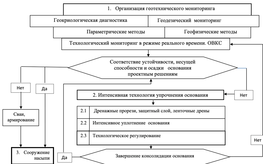
Рис. 1. Принципиальная схема интенсивной технологии и мониторинга земляного полотна при строительстве на высокотемпературной мерзлоте
