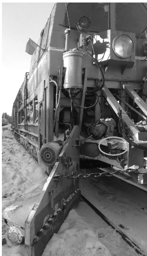
Рис. 2. Излом транспортного крепления бокового крыла
