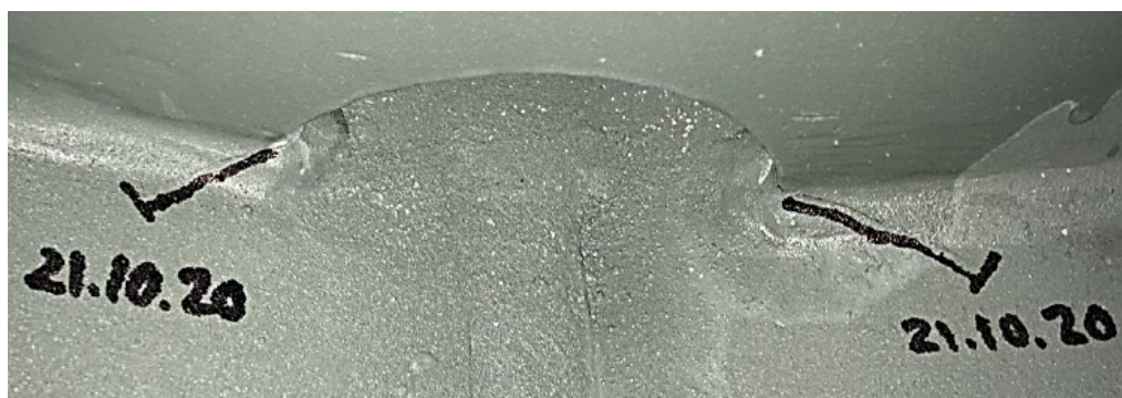
Рис. 3. Усталостная трещина по сварному шву прикрепления поперечного ребра к нижнему поясу с выходом в стенку и нижний пояс (мост через р. Обь на 52 + 551 км подъездной автодороги к г. Сургуту от автодороги Р-404 Тюмень – Тобольск – Ханты-Мансийск)
