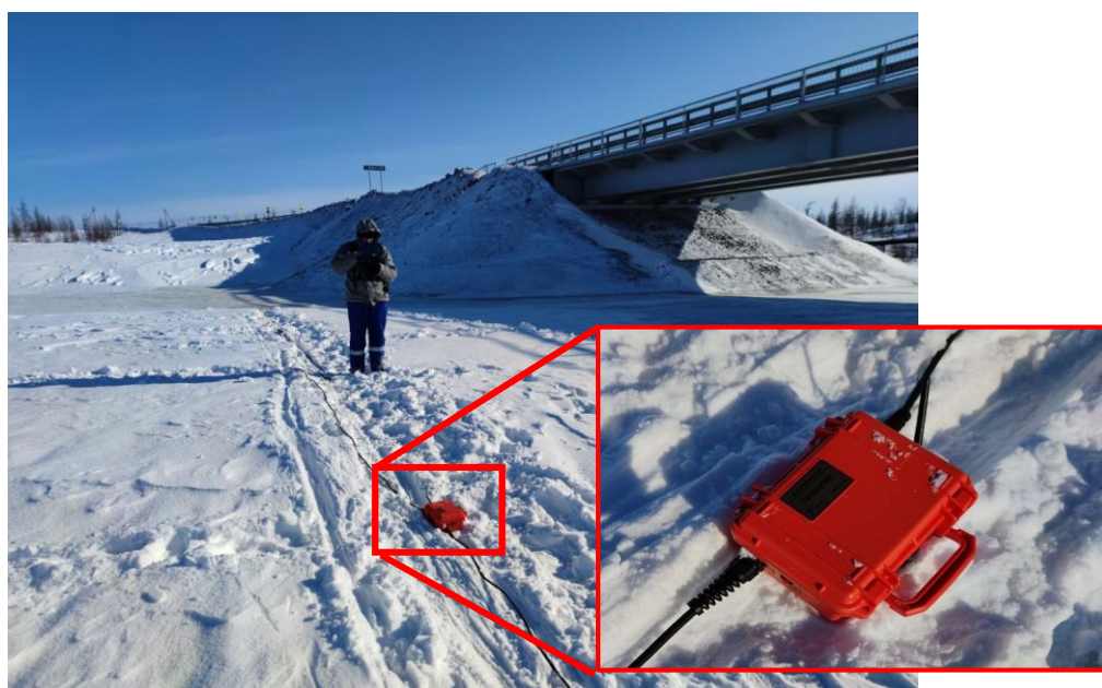
Рис. 7. Выполнение электропрофилирования. Стелющиеся электроды и генератор оборудования «Вега»
