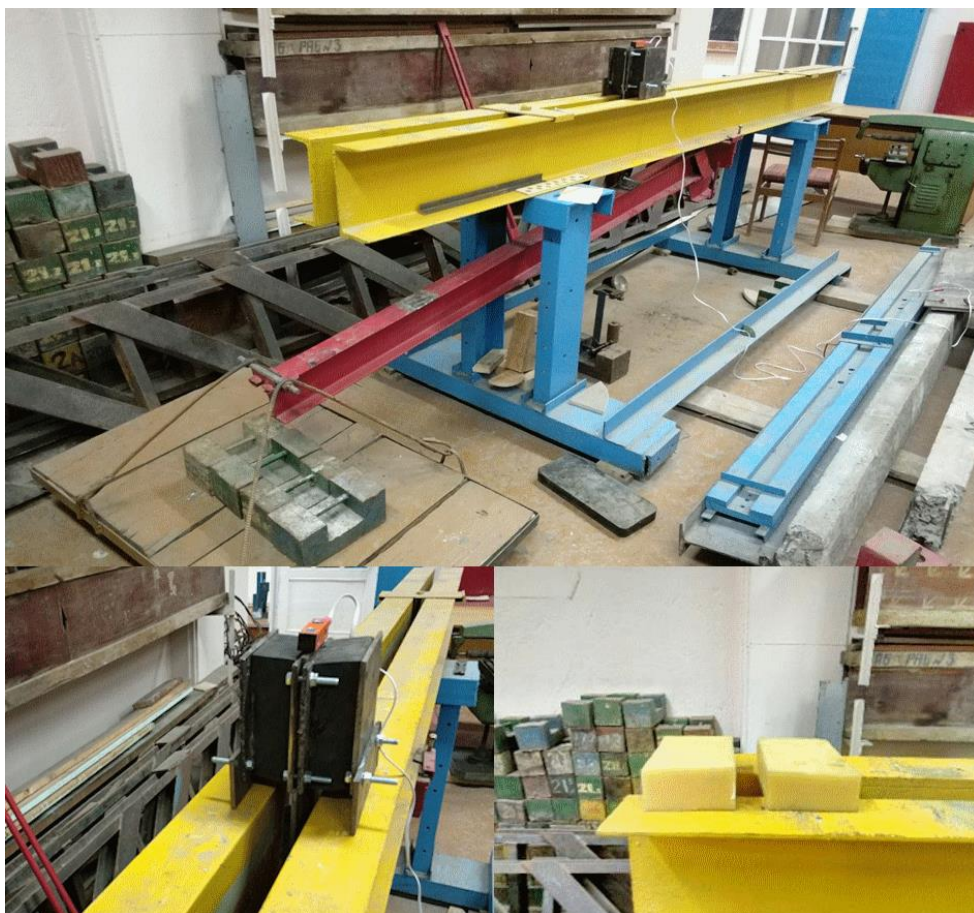
Рис. 4. Фото рычажной установки, фрагменты загрузки РОЧ и образцов «Силагерм 6080»
