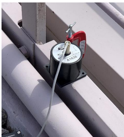
Рис. 1. Приборы, использованные при измерениях: а – трехосный акселерометр; б – видеоэкстензометр
