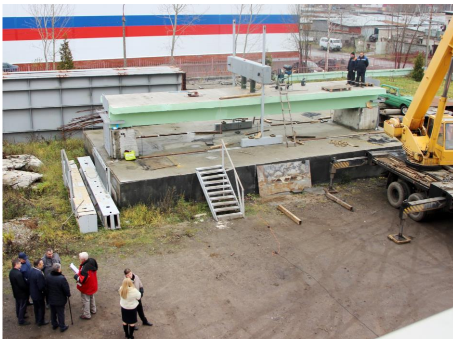
Рис. 7. Нагружение балки с помощью двух домкратов
