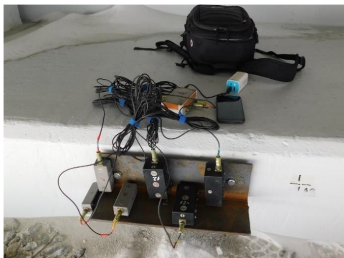
Рис. 5. Общий вид системы «Тензор МС», установленной на опоре
