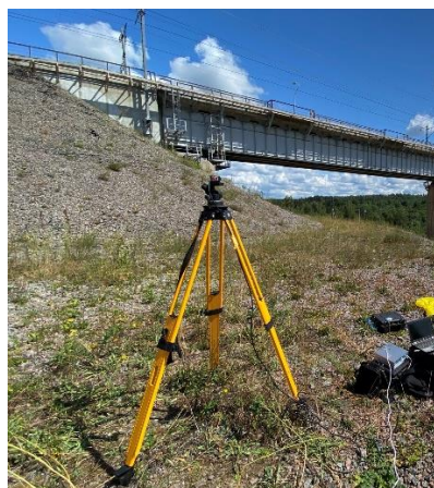
Рис. 1. Приборы, использованные при измерениях: а – трехосный акселерометр; б – видеоэкстензометр
