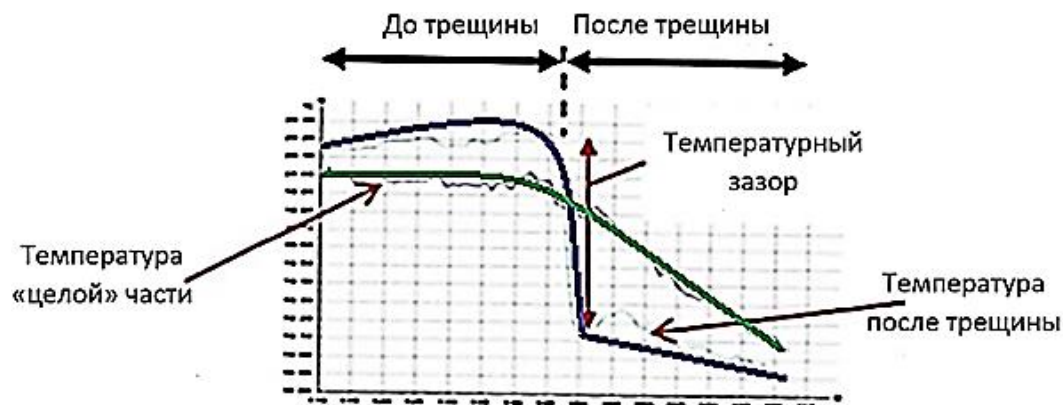
Рис. 6. Принцип метода неразрушающего контроля, основанного на обнаружении температурного зазора, для обнаружения сквозных усталостных трещин в стальных элементах мостов
