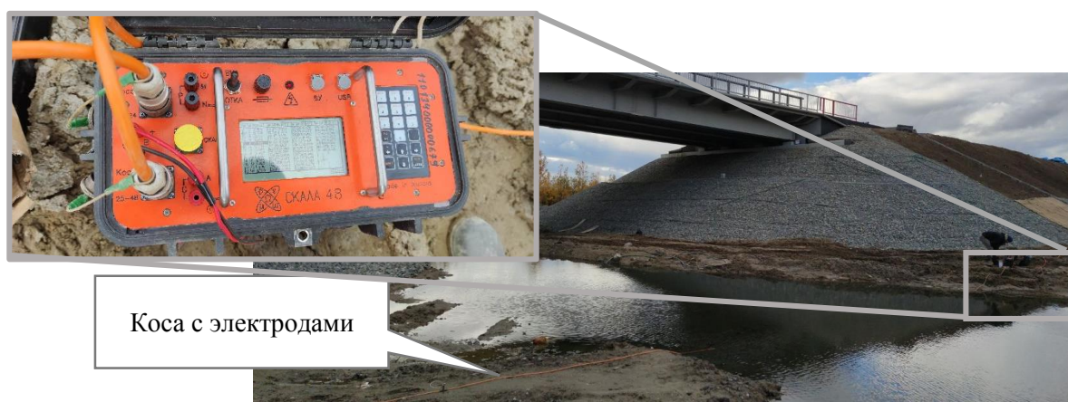
Рис. 6. Проведение электротомографии грунтов прибором «СКАЛА 48»
