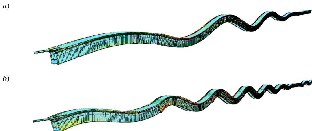
Рис. 9. Собственные формы колебаний модели пролетных строений с учетом верхнего строения пути: а – 1-я форма (вертикальный изгиб), f = 2,48 Гц; б – 3-я форма (S-образный вертикальный изгиб), f = 7,92 Гц
