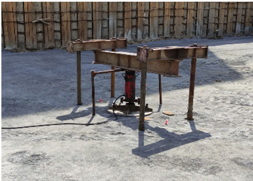
Рис. 2. Штамповое испытание усиленного грунтового массива
