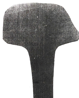
Рис. 1. Профиль головки рельса с большим боковым износом
