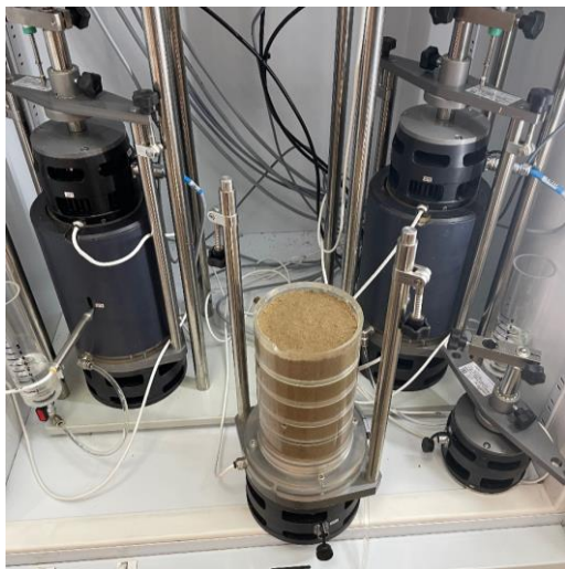
Рис. 4. Подготовленные для проведения эксперимента образцы в приборе ГТ 1.1.12: а – общий вид образца в кольцевой обойме прибора; б – образцы силикатизированного грунта с установленными термоизоляцией и датчиками
