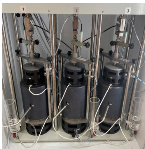
Рис. 4. Подготовленные для проведения эксперимента образцы в приборе ГТ 1.1.12: а – общий вид образца в кольцевой обойме прибора; б – образцы силикатизированного грунта с установленными термоизоляцией и датчиками
