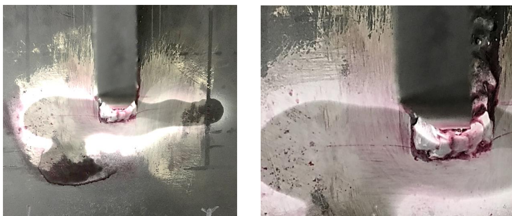
Рис. 6. Выявление трещины капиллярным методом
