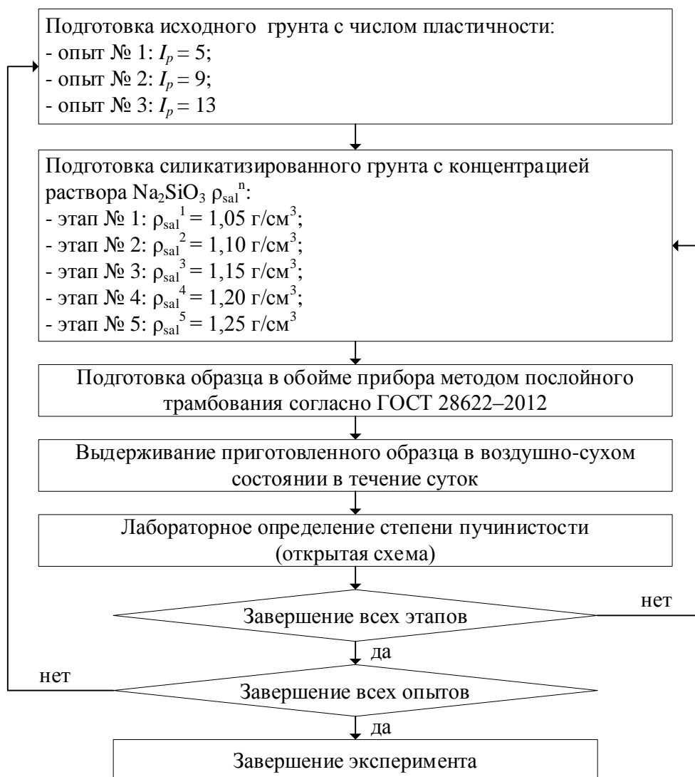
Рис. 2. Последовательность лабораторного эксперимента
