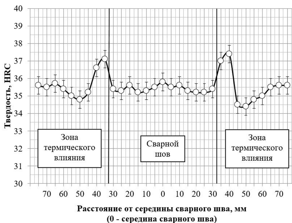
Рис. 8. Твердость поверхности катания в области сварных соединений, полученных по предлагаемой технологии
