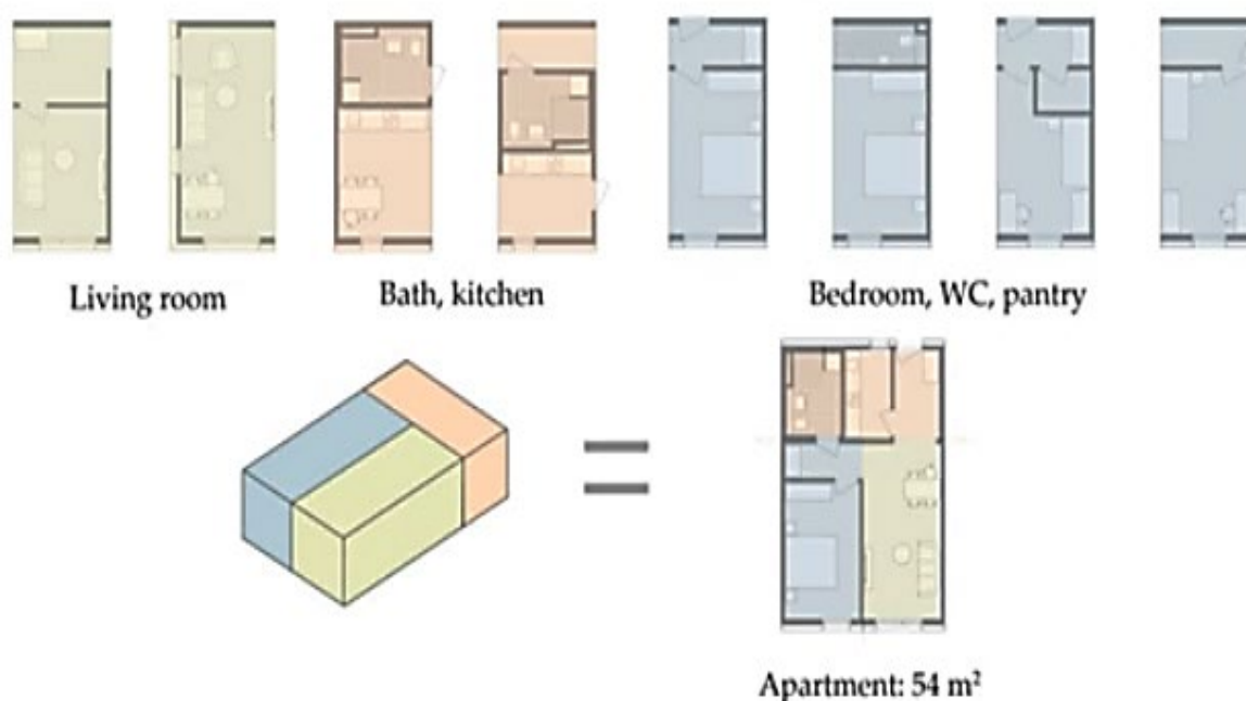
Рис. 9. Конструкция жилого блока на основе системных модулей [5]
