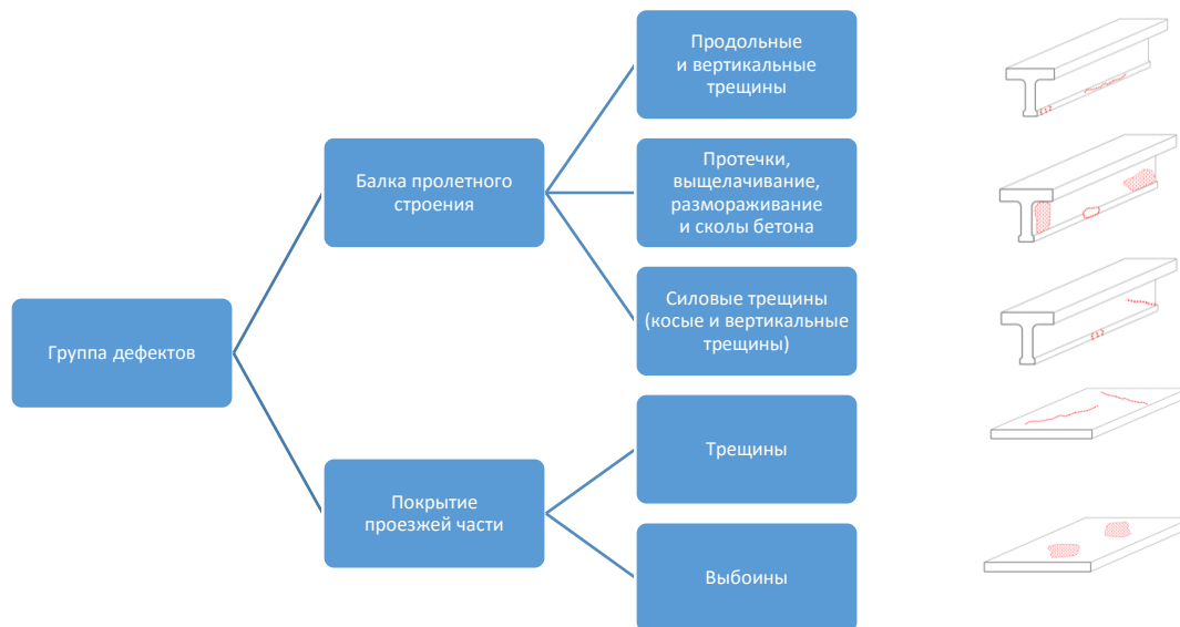
Рис. 2. Основные дефекты пролетного строения и мостового полотна
