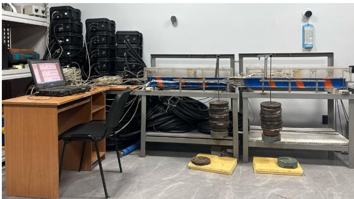
Рис. 5. Макет балочного пролетного строения под нагрузкой 104 кг (2 283,28 Н) и подключенная тензометрическая программно-аппаратная система
