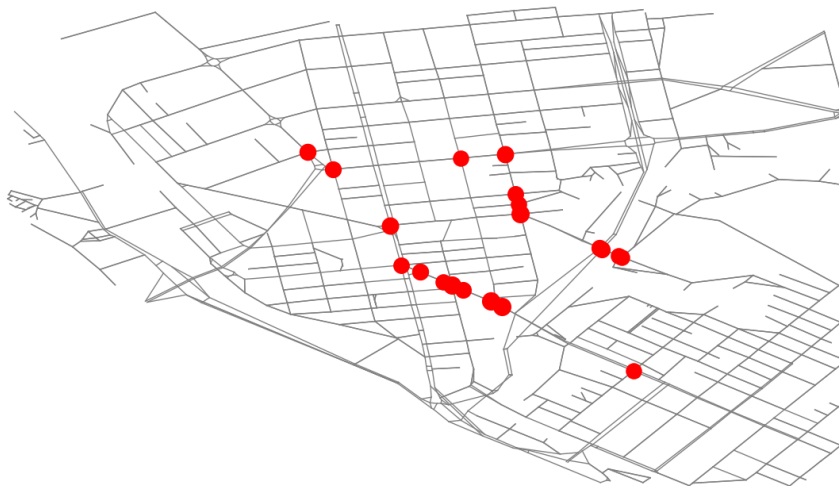
Рис. 2. Граф транспортной сети города с критическими узлами после подсчета комбинированной метрики центральности: жирные точки – критические узлы
