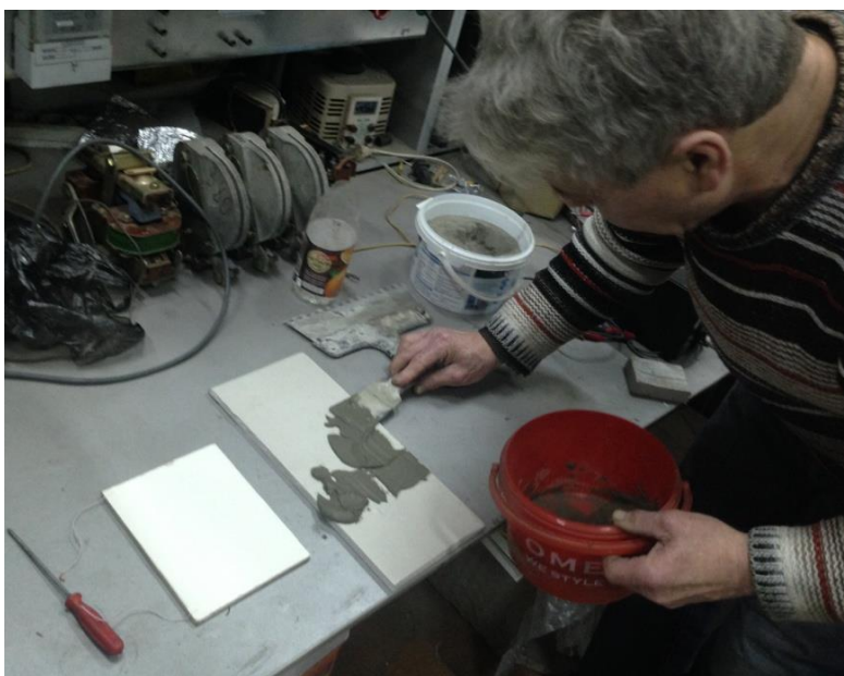
Рис. 2. Процесс нанесения растворов на керамические подложки
