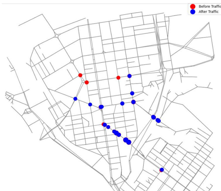
Рис. 3. Результат поиска критических узлов после эмуляции пробок на транспортной сети
