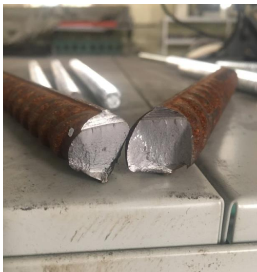
Рис. 5. Характерное поперечное сечение стержня в месте усталостного разрушения
