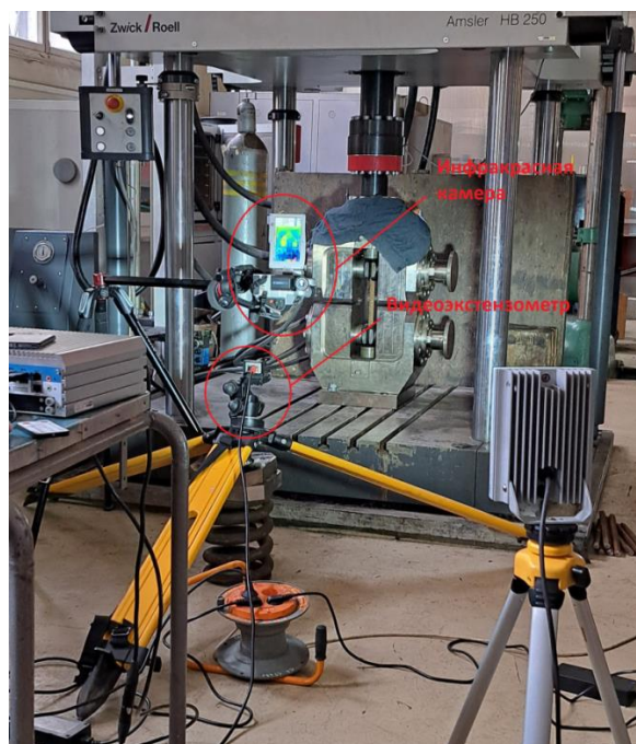
Рис. 4. Общий вид регистрирующих приборов и испытательной машины
