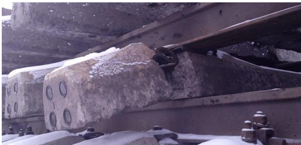
Рис. 2. Разрушение шпалы в подрельсовом сечении
