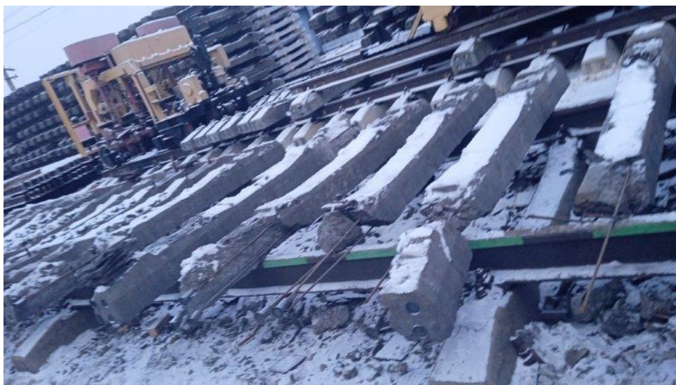
Рис. 1. Разрушение бетона шпалы со стержневым армированием
