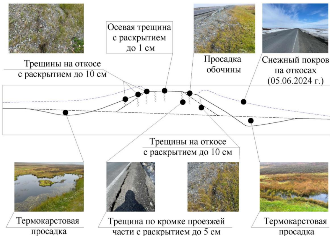
Рис. 1. Схема особенностей деформирования характерного участка земляного полотна
