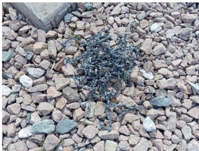
Рис. 6. Объем пластиковой стружки после просверливания двух отверстий под шурупы
