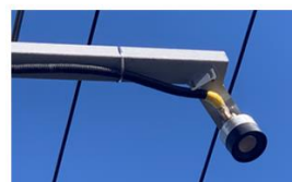
Датчик уровня и скорости течения: Под Стойкой 3-3' - на балке смотрового хода.
