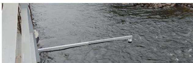
Датчик уровня и скорости течения: Под Стойкой 3-3' - на балке смотрового хода.
