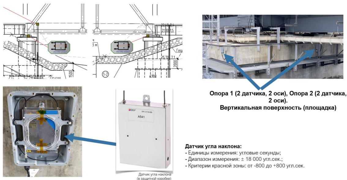
Рис. 8. Пример расстановки инклинометров на мосту через р. Колу
