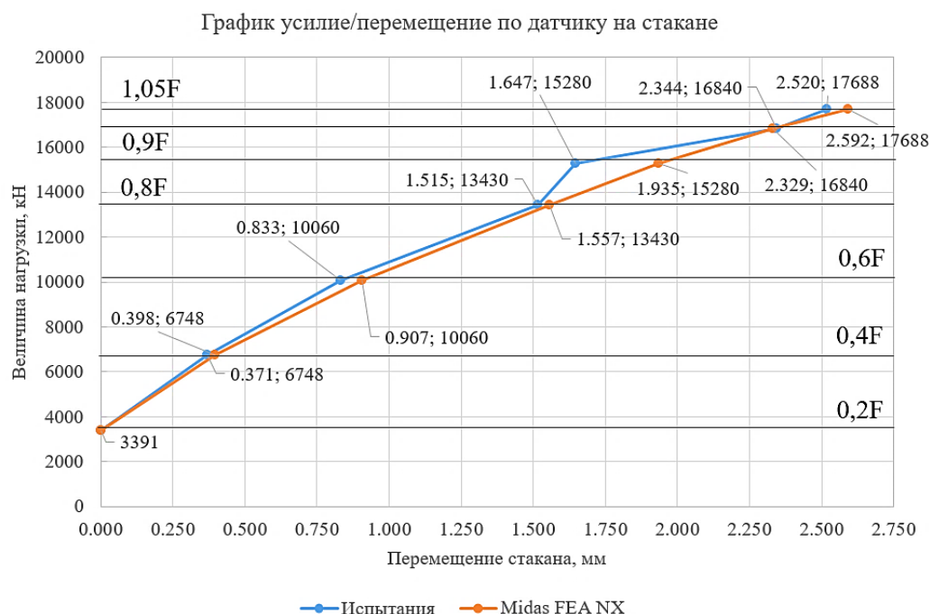
Рис. 7. График сравнения результатов перемещений стакана ОС-55 с результатами расчетов в Midas FEA NX
