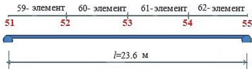
Рис. 3. Разделение пролетного строения длиной 23,6 м на конечные элементы
