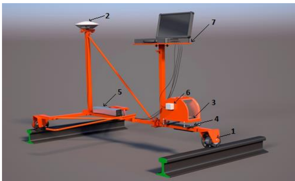
Рис. 7. Система контроля габаритов приближения строения СКГ- 2.1: 1 – ходовая тележка; 2 – спутниковый приемник; 3 – лидар; 4 – система стабилизации; 5 – инерциальная система ; 6 – радиомодем; 7 – компьютер
