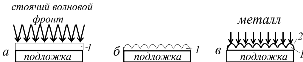
Рис. 3. Изготовление растр-реплики: а – регистрация волнового фронта; б – поверхность фотоэмульсии 1 после химической обработки; в – напыление слоя металла 2
