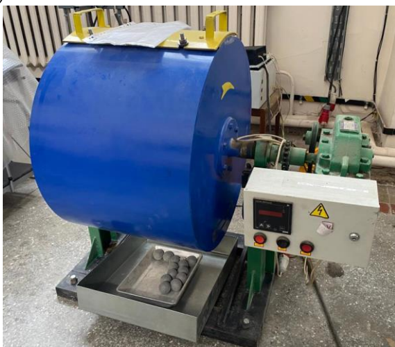
Рис. 2. Испытательное оборудование, использованное при проведении исследований износостойкости щебня: а – полочный барабан; б – установка «Микро-Деваль»
