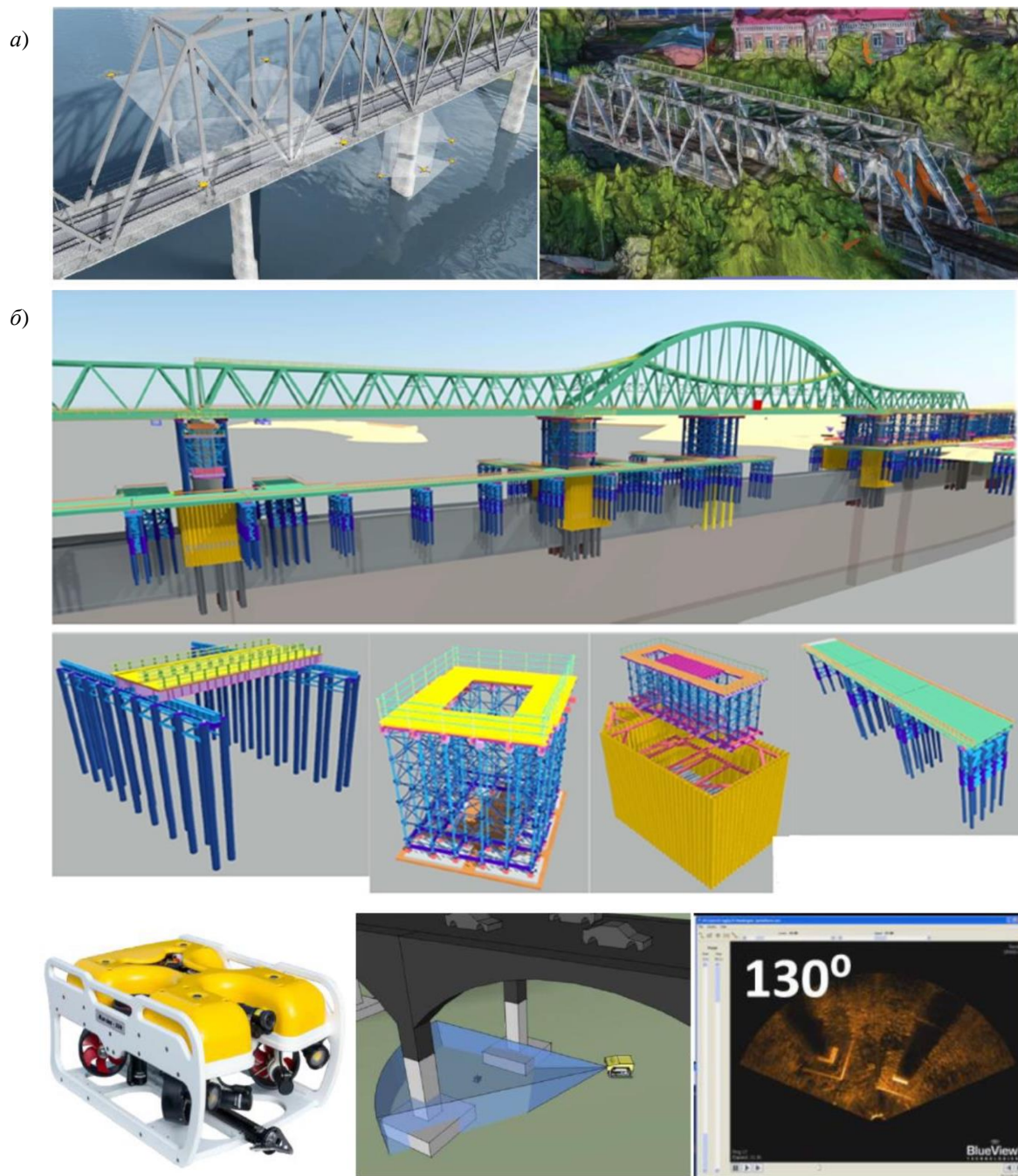
Рис. 1. Инновационные методы диагностики железнодорожной инфраструктуры: а – применение беспилотных летательных аппаратов при диагностике мостов; б – применение беспилотных подводных аппаратов при обследовании подводной части мостов
