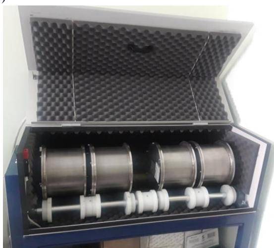
Рис. 2. Испытательное оборудование, использованное при проведении исследований износостойкости щебня: а – полочный барабан; б – установка «Микро-Деваль»
