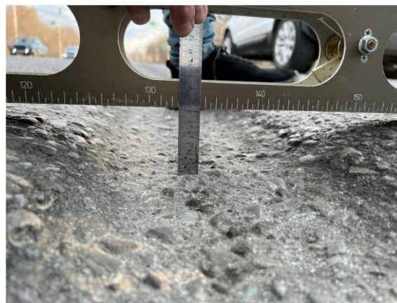
Рис. 1. Колея покрытия на объекте, находящемся в эксплуатации 3,5 года (величина износа более 6 см)
