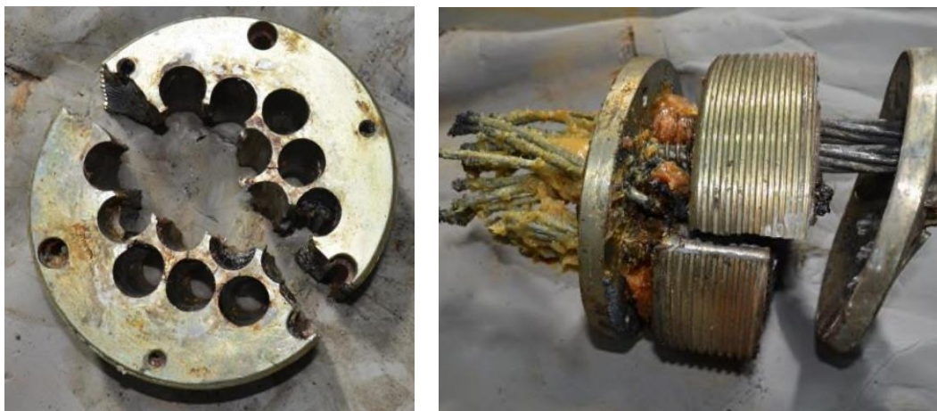
Рис. 1. Разрушенная анкерная колодка узла крепления подвески
