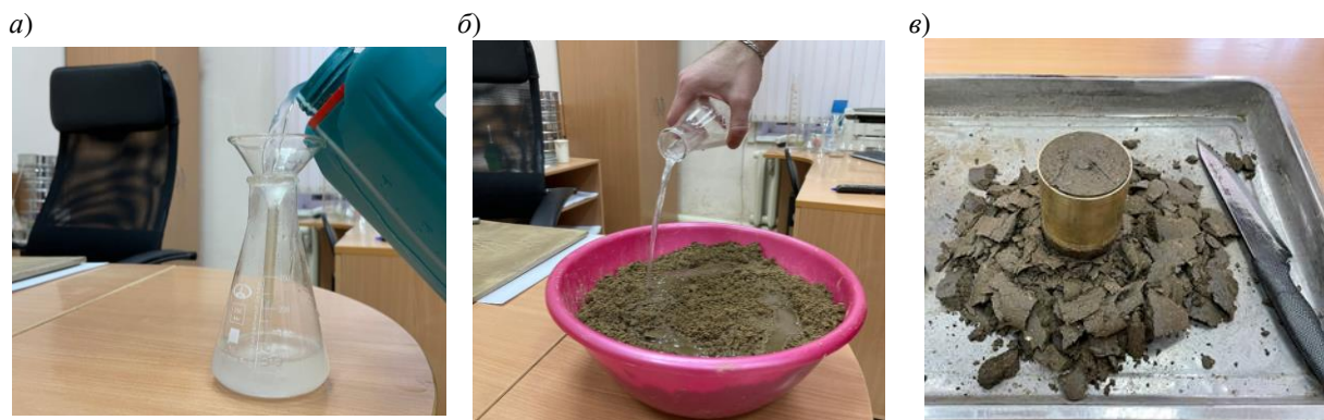
Рис. 3. Изготовление образцов силикатизированного грунта: а – подготовка раствора силиката натрия требуемой концентрации; б – пропитка исходного грунта раствором силиката натрия; в – подготовка грунтового цилиндра
