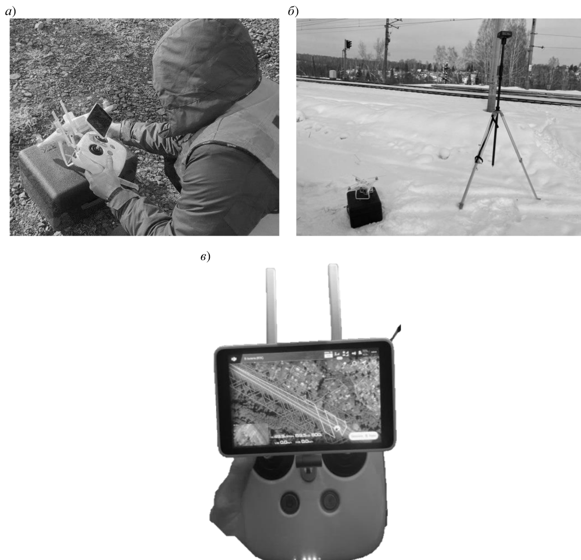
Рис. 3. Исполнительная съемка на участке исследования: а – калибровка дрона; б – установка привязки; в – построение маршрута
