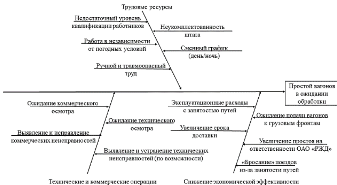
Рис. 2. Факторы, влияющие на простой вагона на станции
