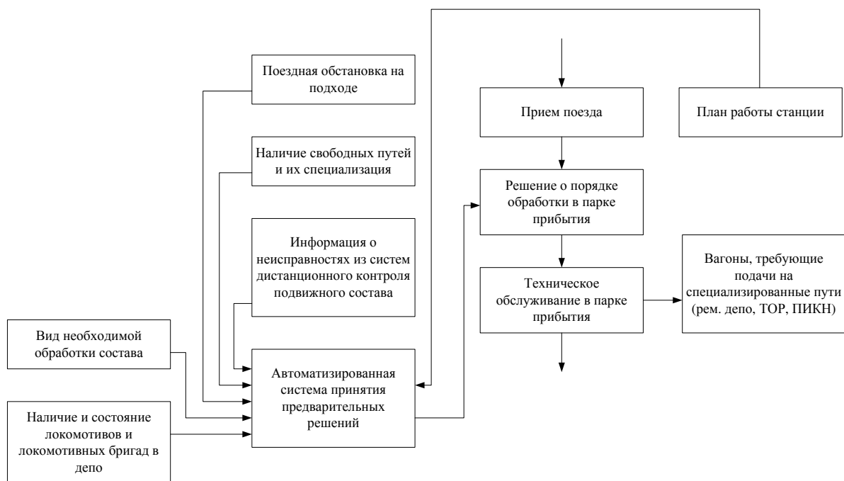
Рис. 3. Оптимизированный алгоритм работы (этапы А–В на рис. 1) после создания автоматизированной системы принятия предварительных решений
