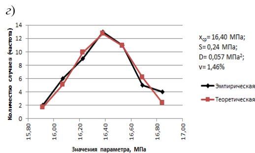
Рис. 4. Кривые распределения напряжений в контрольных элементах при проезде одиночных локомотивов 2ЭС6:
