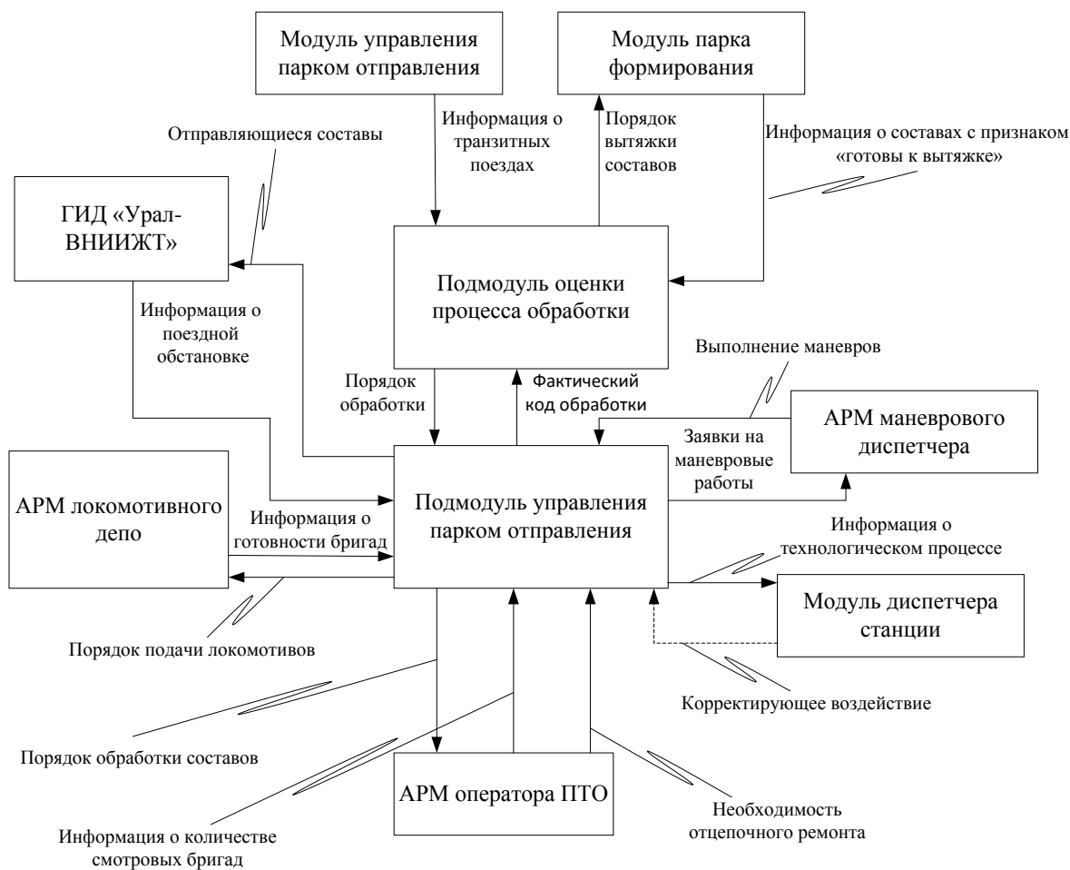
Рис. 4. Схема взаимодействия модуля парка отправления с другими модулями
