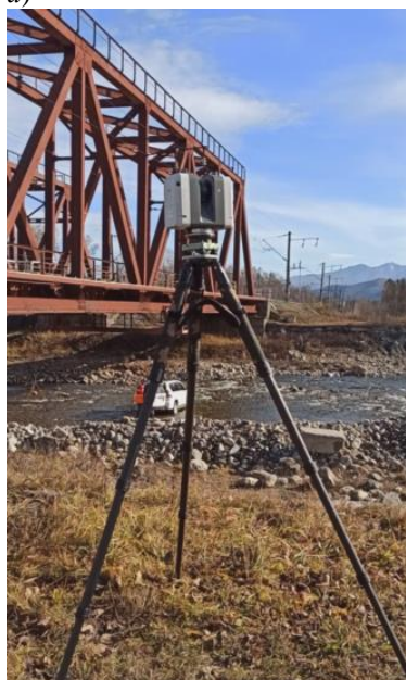
Рис. 2. Сканирование пролетного строения (а) и облако точек (б)
